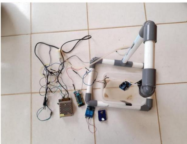
**Gambar 3** Rancangan Desain filter air batok kelapa berbasis microcontroller
