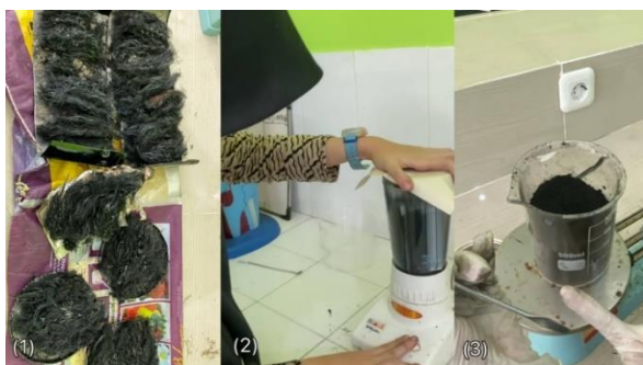
Gambar 2. Proses pembakaran meliputi: (1) Hasil pembakaran menggunakan oven; (2) Proses penghancuran arang; (3) Serbuk arang TKKS.
