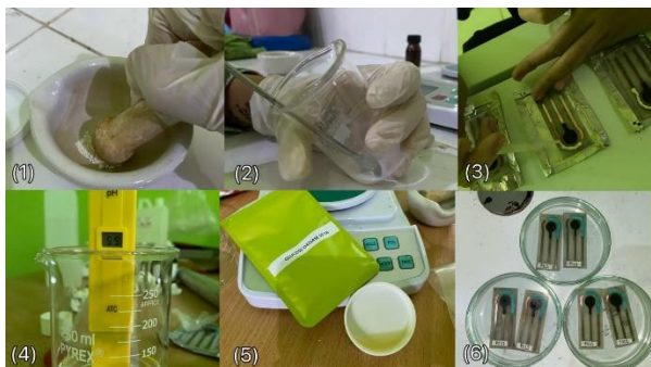
Gambar 5. Preparasi enzim: (1) Penghalusan partikel AgCl; (2) Pembuatan pasta AgC; (3) Drop-casting elektroda referensi; (4) Buffer pelarut enzim pH 5,5; (5) enzim glukosa oksidase; (6) Inkubasi enzim.
