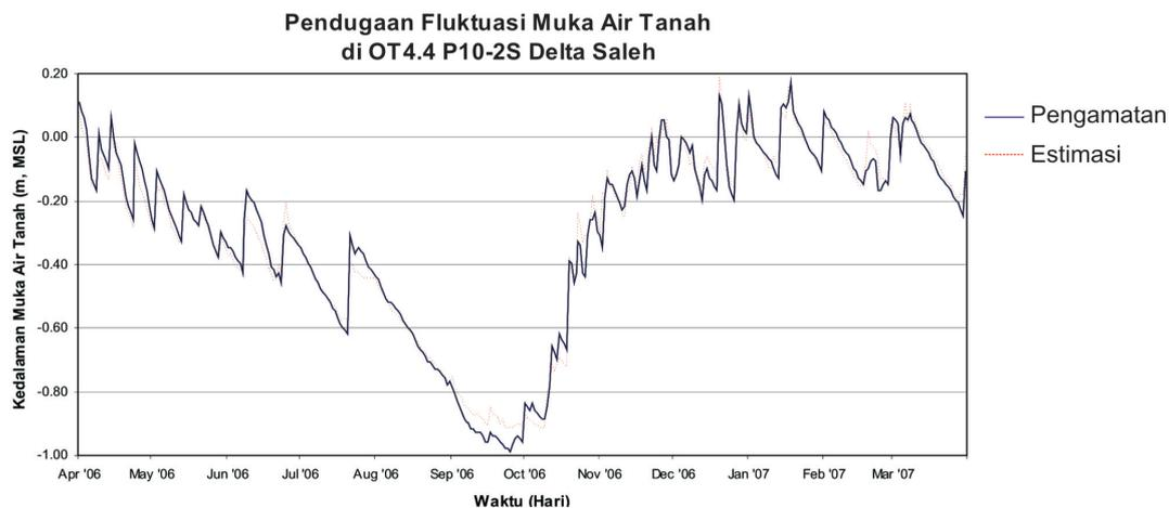
GAMBAR 3: Pendugaan fluktuasi muka air tanah pada lahan rawa pasang surut tipe C/D di titik pengamatan OT4.4 P10-2S Delta Saleh
