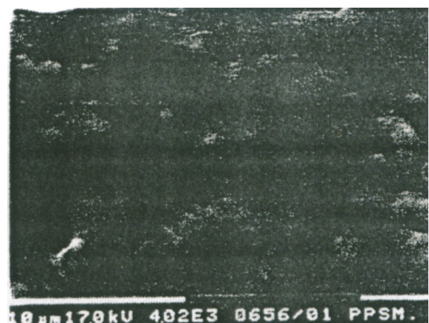
GAMBAR 6: Struktur mikro alumina +4% \text{TiO}_2 setelah dipanaskan pada suhu 1400°C selama 120 menit
