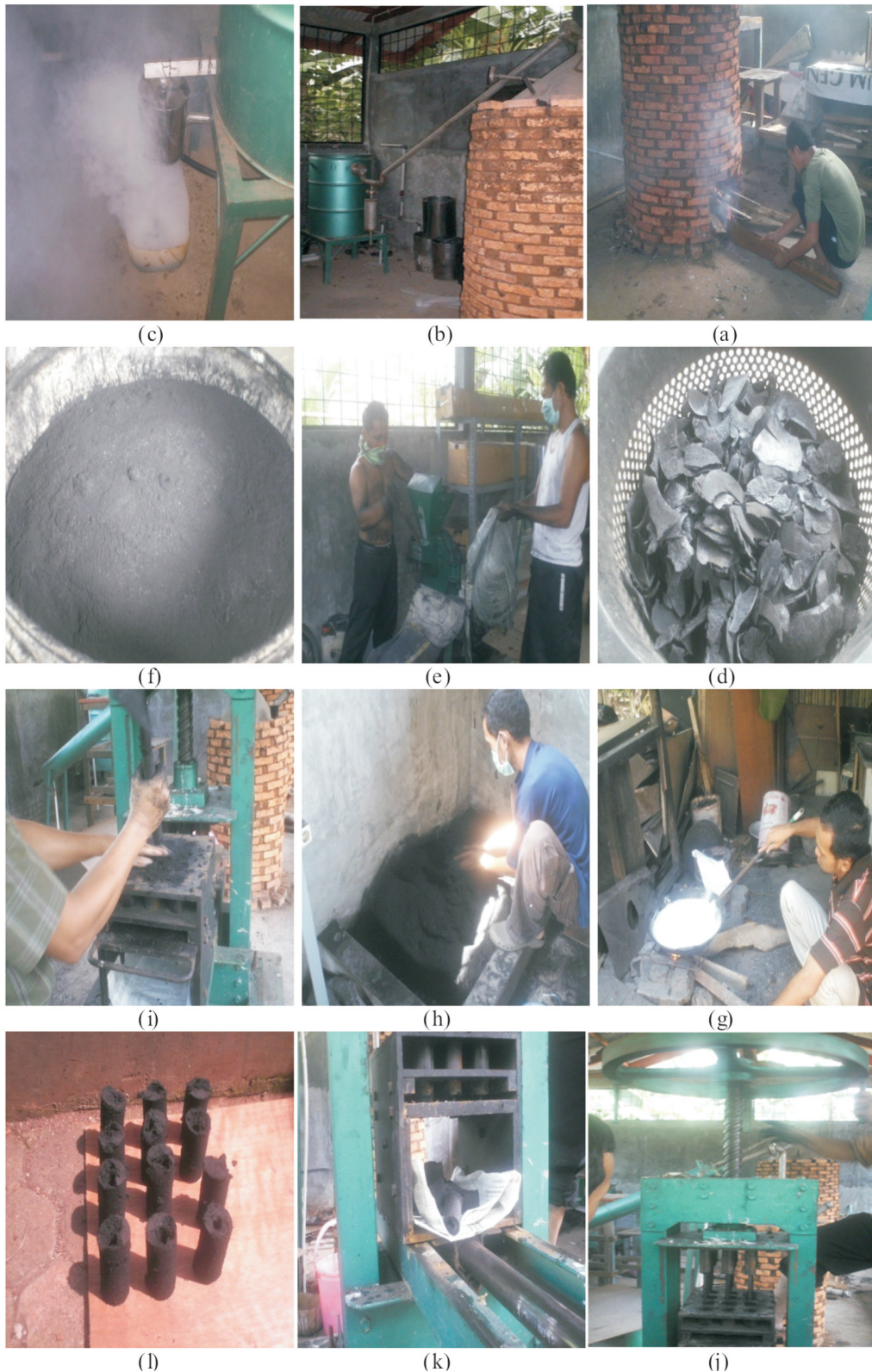
GAMBAR 1: Proses fabrikasi briket arang tempurung kelapa (a) tempurung kelapa dipanaskan (proses pirolisis) di dalam tungku, (b),(c) selama proses pirolisis asap yang dihasilkan dialirkan ke drum pendingin melalui pipa sehingga terjadi kondensasi (pengembunan), (d),(e),(f) Setelah arang terbentuk kemudian digiling hingga membentuk serbuk halus; (g),(h),(i) bahan serbuk arang dicampur dengan tepung kanji yang dimasak menjadi lem untuk kemudian dicetak; (j),(k),(l) Proses pencetakan dengan cara pemadatan hingga membentuk briket dan dijemur hingga kering
