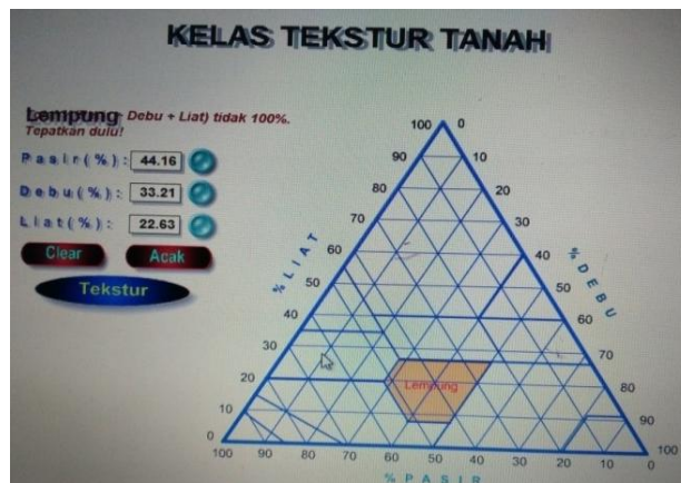
Gambar 4.9. Tekstur tanah rerata 3 fraksi dengan menggunakan metode pipet hasil laboratorium pada kawasan rencana pengembangan ruang terbuka hijau (RTH) Taman Pemakaman Umum (TPU) Borang Sako
