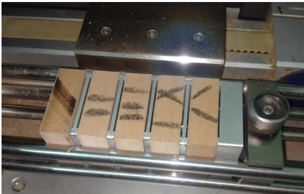
Gambar 2. Posisi sampel rawboard di uji dengan alat density profile meter analyzer DPX200 IMAL.
