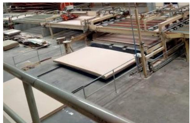
Gambar 1. Posisi rawboard disanding dalam pabrik
