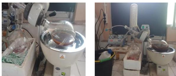
**Gambar 3** Proses evaporasi dengan rotary evaporator, suhu evaporasi 40 °C dan 65 °C
