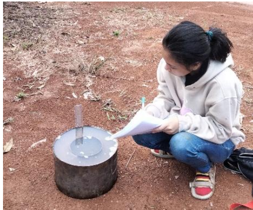
Gambar 2. Infiltrasi Tanah Menggunakan Infanometer
