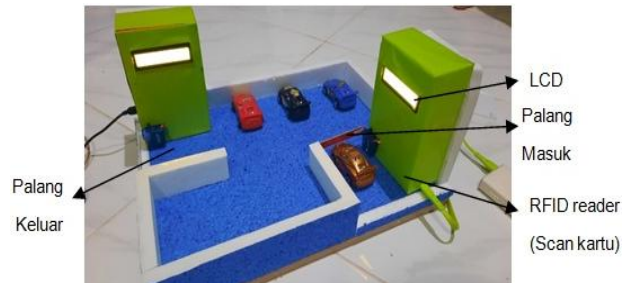
Gambar 9. Prototype sistem pintu palang otomatis lahan parkir
