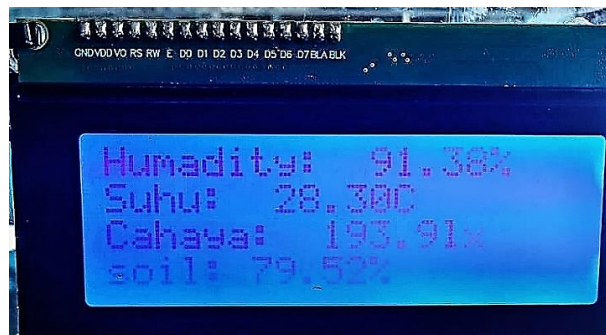
Gambar 10. Hasil tampilan Kelembaban Tanah pada LCD
